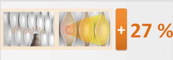
Doté d'élément 3D en forme de vague, sa surface d'échange thermique est plus importante, de ce fait OASIS offre une montée en température plus rapide de 27% comparé à un radiateur bain d'huile classique.
