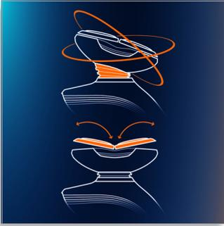
Le système de suivi des contours GyroFlex 2D s'adapte parfaitement aux courbes du visage pour un rasage de près avec moins de pression et moins d'irritations.
